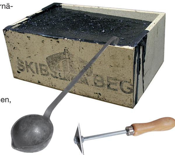
bekannten Pechschrapper entfernt. Aber so, dass das Pech nicht ausbricht und auch das Holz nicht beschädigt wird. Sollte es notwendig sein, wird die Fläche mit dem „Ossen“ gehobelt, aber lange Züge! Nicht den Doppelhobel nehmen und aus Faulheit nur kleine Flächen putzen, das gibt Dellen und an Deck ewige Pfützen. Da leckt und fault es zuerst.
