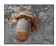
Korrodierte VA-Schraube in Alu
